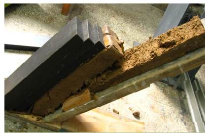
(b) 有冻融界面试件的最终破坏形式
