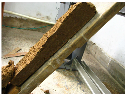
图 3 普通土试件破坏形式
